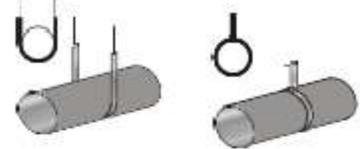
8. Soporte el ducto entre una conexión de metal y un doblez, permitiendo al ducto extenderse derecho unas cuantas pulgadas antes de hacer el doblez.
