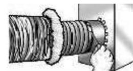
3. Vuelva a colocar el aislamiento y la cubierta metálica. Envuelva la cubierta con al menos dos vueltas de cinta para ducto. También puede usarse una abrazadera.
