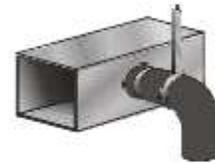
9. Los conductos instalados verticalmente tienen que ser estabilizados por cinchos a un máximo de seis pies entre soportes a través del centro.
