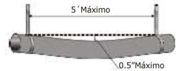
7. El material que soporta al tubo no debe ser menor a 1.5 pulg. (38mm) de ancho y no debe afectar el diámetro del ducto.
